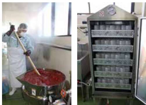
蒸気釜でトマトを煮込む職員（写真左）と 容器を殺菌する設備（写真右）。
